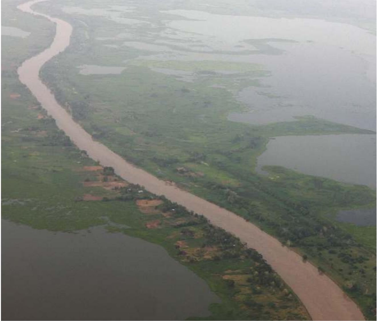
Figura L. Municipio de Arjona, 2005. El canal atraviesa ciénagas desde Calamar hasta Pasacaballos, excepto en los 500 metros del corte de Paricuica. Sus muros laterales, ampliados tres veces en el siglo XX, fueron formados por los dragados, así como las islas longitudinales que se aprecian en las ciénagas a ambos lados del canal. Foto cortesía de El Universal.
